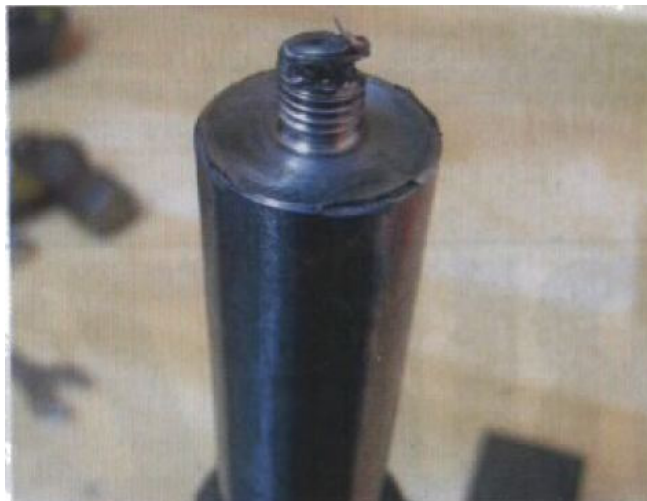
Uszkodzony gwint wałka popychacza typu EFL
