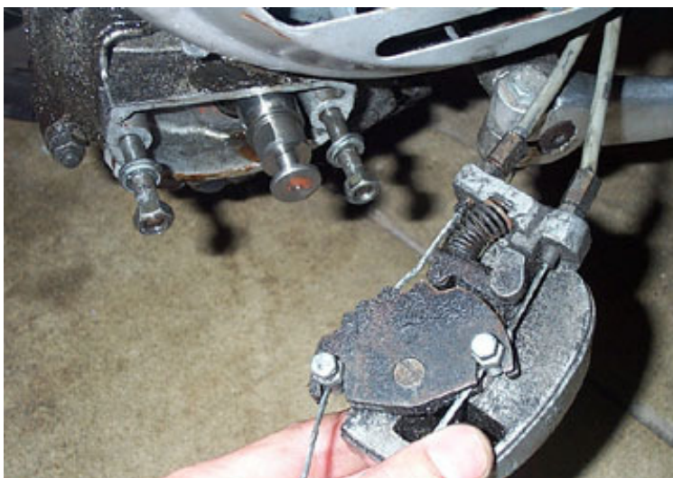
Zmieniacz starego typu. Linki nie są zawijane – przechodzą na wprost.
