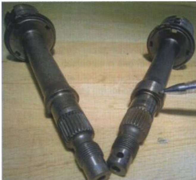
Wálki EFL pod uszczelniacz zewnętrzny (z lewej) i wewnętrzny (z prawej). Wskazana jest bieżnia uszczelniacza dodana w późniejszych modelach.
